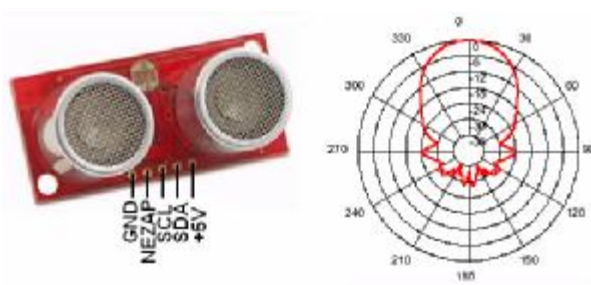
Obr.11. SRF08 a jeho smerová charakteristika
