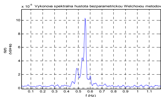
Obrázok 4: Výkonová spektrálna hustota signálu bezparametrickou Welchovou metódou
