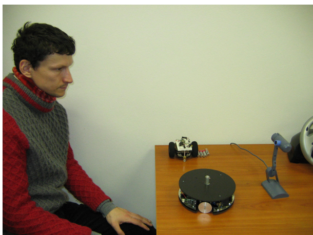
Obr. 1 Kalibrácia vnútorných a vonkajších parametrov kamery pomocou šachovnicového vzoru (vpravo) a riadenie robota podľa pohybov tváre subjektu sledovaného jednoduchou webkamerou (vľavo).
